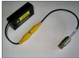
Поворотное зеркало Позволяет измерять под углом 90° к оси опт.головки. [ACSTRAM].
